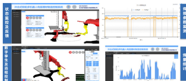
图7 机器人电弧增材制造集成控制系统
