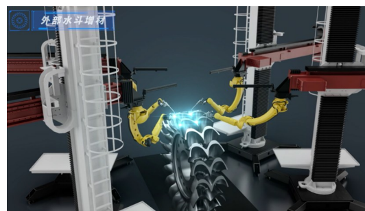
图6 外部水斗增材制造系统
