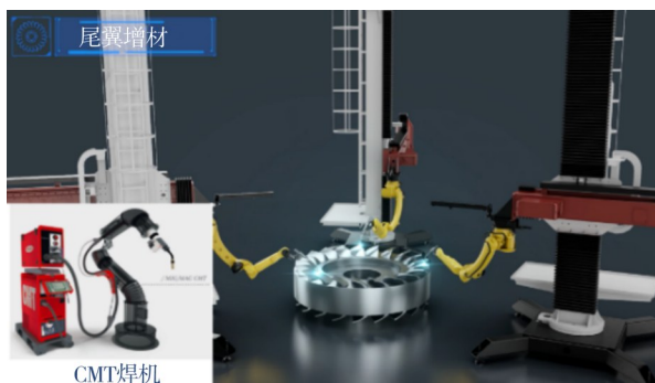
图4 水斗尾翼机器人电弧增材制造系统
